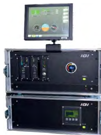
Die IGI Mobile Mapping Steuerungs-einheit mit unterbrechungsfreier Stromversorgung.
